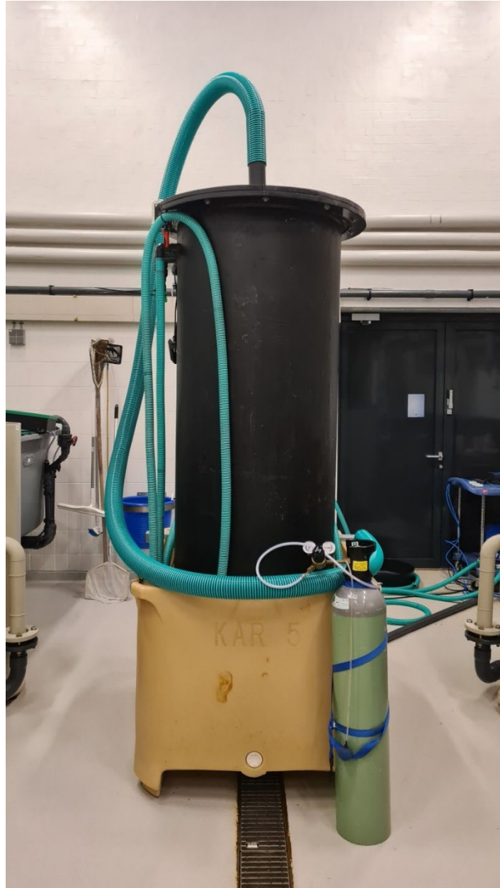
Figur 16. Afgasningstårn til fjernelse af CO 2 . Konfiguration kunne ændres for at opnå forskellige vandtilførselsrater, lufttilførsel og forskellige højder af mediet inde i tårnet.
